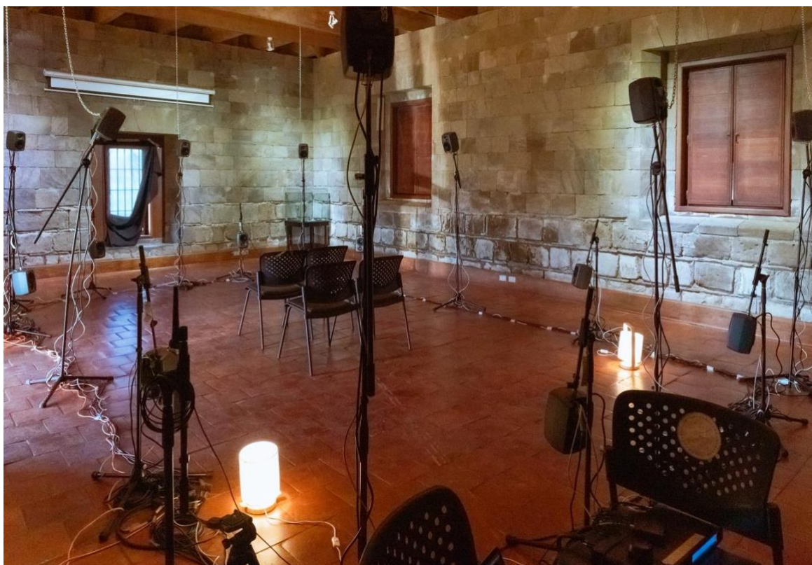
Figura 3: Sistema de 16 canales utilizado para las pruebas auditivas, Museo de Sitio Castillo de Niebla.
