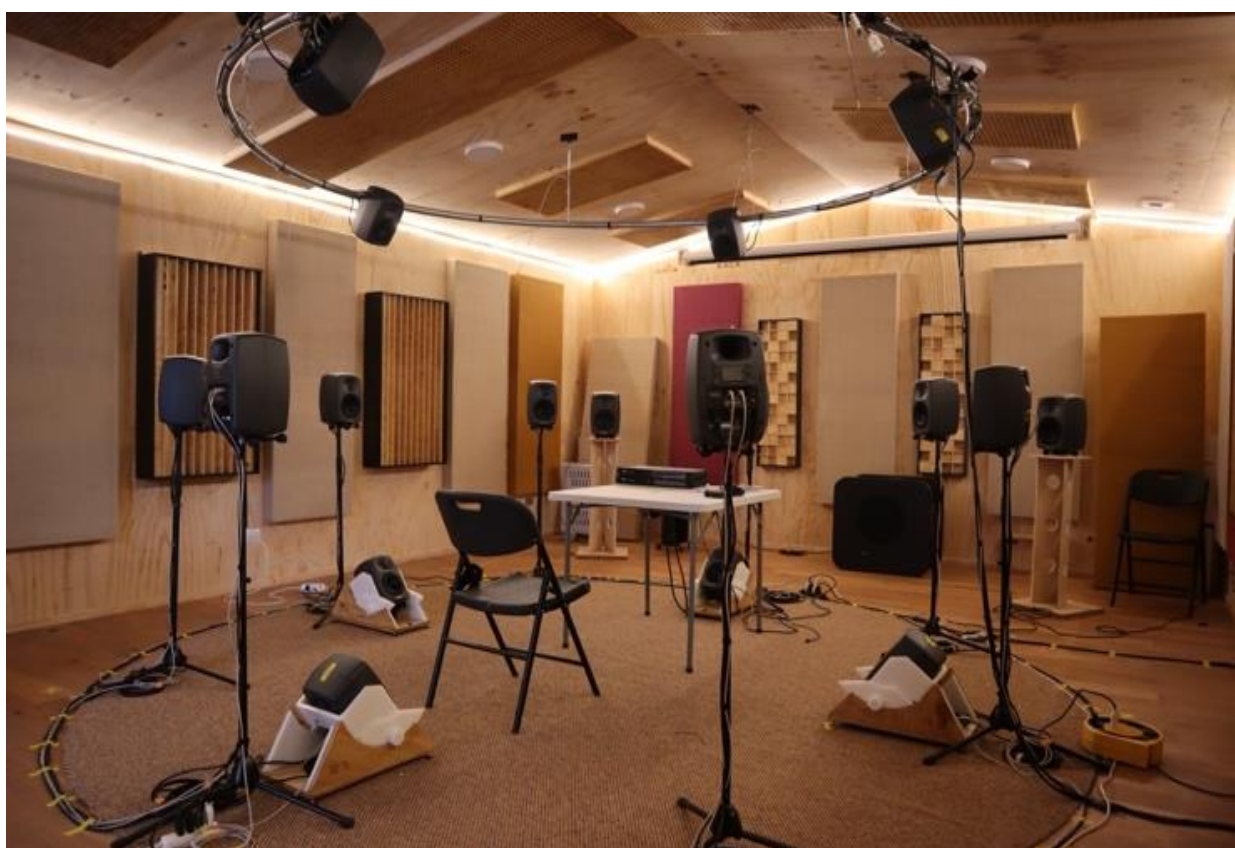
Figura 2: Sistema de 12 canales en recinto acústicamente controlado utilizado para las pruebas auditivas, Laboratorio de Artes y tecnología.
